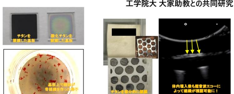
生体材料として広く用いられているチタンやジルコニウム、およびその酸化物をスパッタ成膜し、生体との親和性が高い表面を作製したり(左)、体内に埋め込む組織にダメージレスで金属膜を作製し、超音波エコーによる組織の非侵襲的な状況確認を可能とする研究(右)を行っています。
