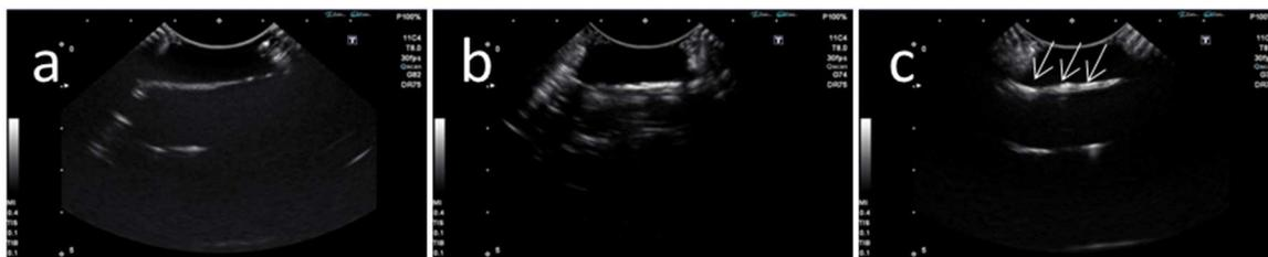
図 1 各試料のエコー画像. (a)未製膜の脱細胞化組織, (b)シリコンウェハ, (c)チタン酸化物を部分的に製膜した脱細胞化組織
